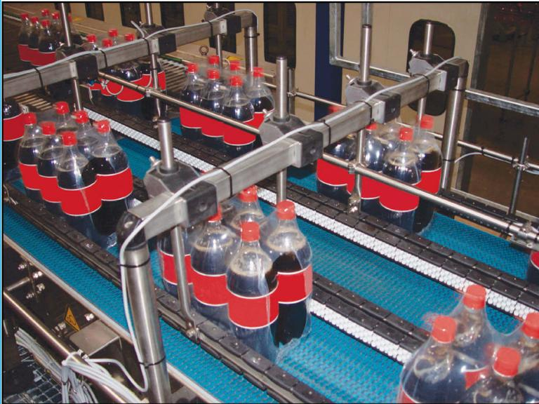
**Förderanlage für positionierte Produkte für Palettierer**
